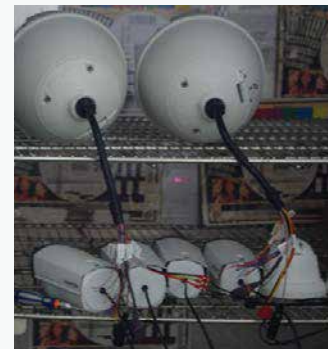
اتاقک تست دستگاه در برابر شرایط دمایی بسیار بالا و بسیار پایین
