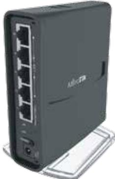
hAP ac<sup>2</sup> نیز امکان پوشش دهی Wi-Fi را بطور همزمان در دو باند 2.4 و 5 گیگاهرتزی فراهم می سازد. hAP ac<sup>2</sup> دارای پنج پورت گیگابیت اترنت است و از پورت USB دستگاه می توان جهت افزودن فضای ذخیره سازی یا اتصال مودم های 4G/LTE استفاده نمود. طراحی جدید بدنه امکان قرارگیری دستگاه بصورت افقی (رومیزی) یا ایستاده را فراهم می سازد.
